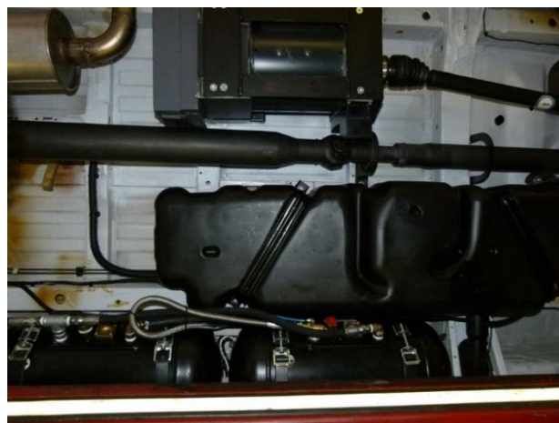
Générateur et réservoirs d'air en dessous le véhicule
